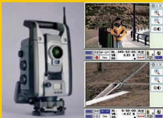
レンズで視準している視野をリアルタイムに表示パネル上に映し出します。
